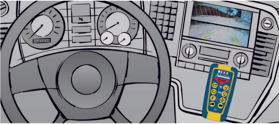
Rangieren mit Lkw und Standard Cargolift an der Rampe erfordert viel Übung – oder die Bär SmartControl Fahrerhaussteuerung. Zusammen mit zwei Rückfahrkameras und einem Monitor im Fahrerhaus können Sie den Cargolift perfekt in Position bringen und bedienen – exklusiv bei BÄR mit Orientierungslinien am Monitor (patentiert).
