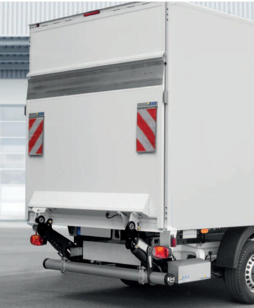
Nutzlast ist vor allem in den leichten Fahrzeugklassen das zentrale Thema. Deshalb macht Ihnen der BC 750 S2L ein attraktives Angebot: Er hebt 750 kg bei einem Lastabstand von 600 mm und bringt dabei selbst nur 160 kg auf die Waage (Plattform 1410 mm x 2100 mm). Was laden Sie für die gewonnenen 20 kg ein?
