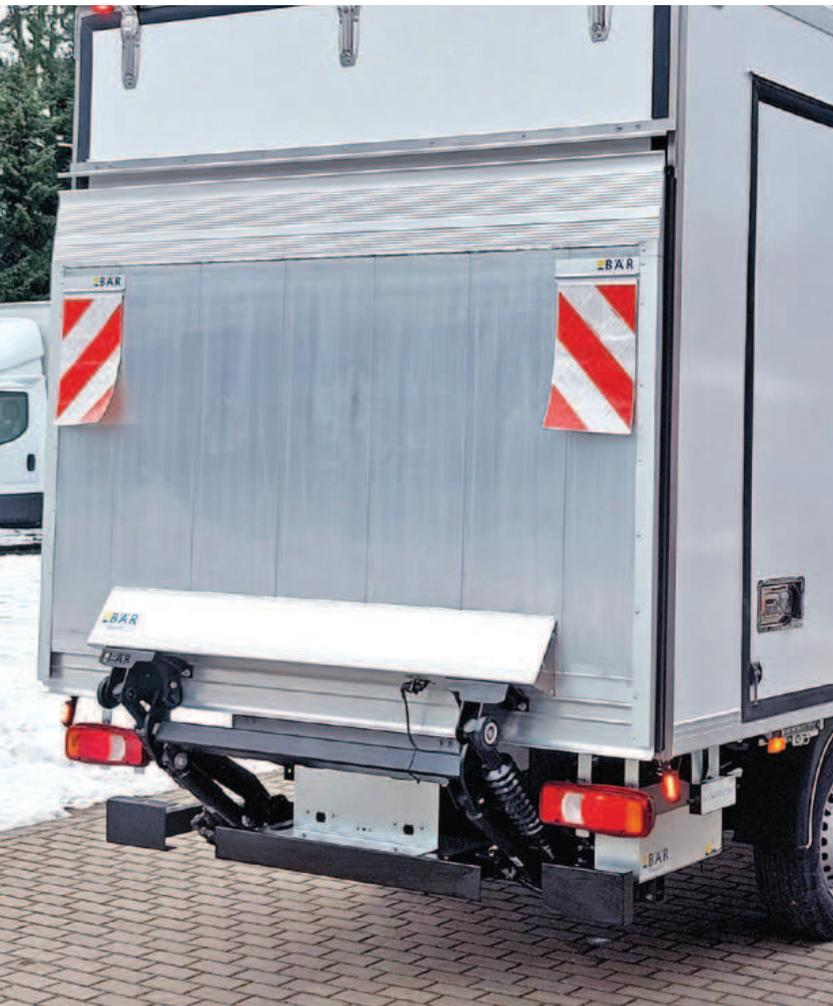
Der BC 750 S4 verfügt über einen feststehenden Unterfahrschutz, in welchen einfach und gewichtsgünstig ein Anhängelock für Kugelkopfkupplung integriert werden kann. Im Gegensatz zu den alternativen Cargolifts mit Tragkraft 750 kg hat der BC 750 S4 vier Zylinder. Das Basishubwerk wird über fahrzeugspezifische Anbausätze montiert.
