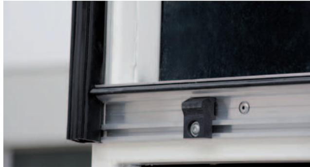
Dichtsystem **CargoSeal** (Option S2 / S4) für zuverlässig dichten Heckabschluss bei aufbauverschließender Plattform.
