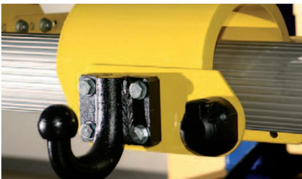
Anhängebock für Kugelkopfkupplung S2L / S2S / A2L
