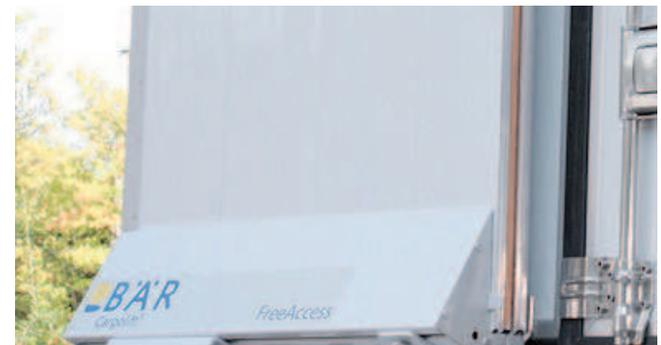
Plattformrückseite **pulverbeschichtet** in RAL 9006 Weißaluminium. Randabschlussprofil **eloxiert** (Serie A2L).
