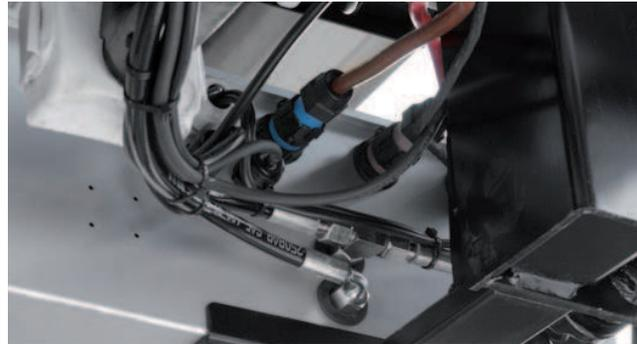
**Elektrische Schnittstelle VDDH** (Serie) für den einfachen elektrischen Anschluss.
