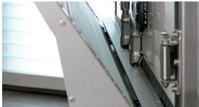
Bär **CargoBridge** (Option) für Anbau der Plattform hinter Koffertüren mit Drehstangenverschlüssen. Erspart aufbauseitige Überfahrmasse.
