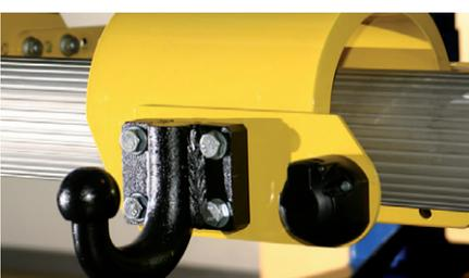
Anhängenbock für Kugelkopfkupplung S2L / S2S / A2L
