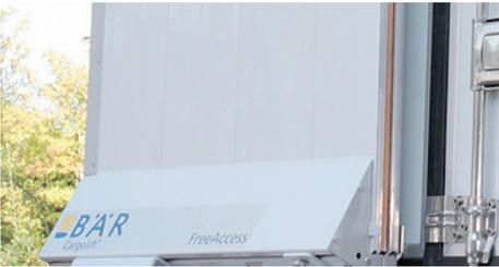
Plattformrückseite **Aluminium** Natur (Serie S2 / S4) oder **pulverbeschichtet** in RAL 9006 (Serie A2L). Option S2 / S4: Pulverbeschichtet in Wunsch-RAL-Farbtone oder eloxiert.
