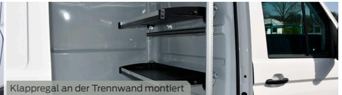
Klappregal an der Trennwand montiert
