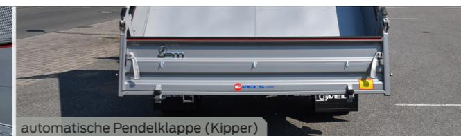
automatische Pendelklappe (Kipper)
